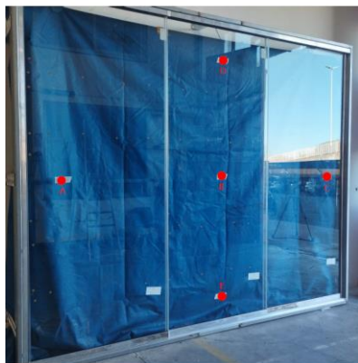
Campione durante la prova al vento
