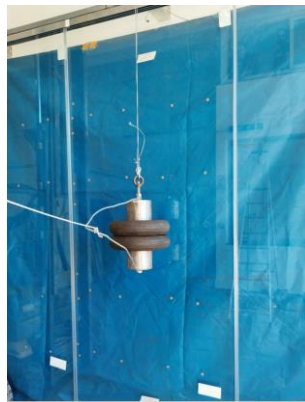
Campione durante la prova d'impatto
