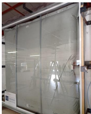
Campione durante la prova al vento
