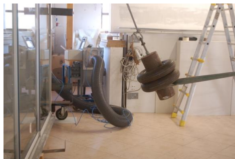
Campione durante la prova d'impatto
